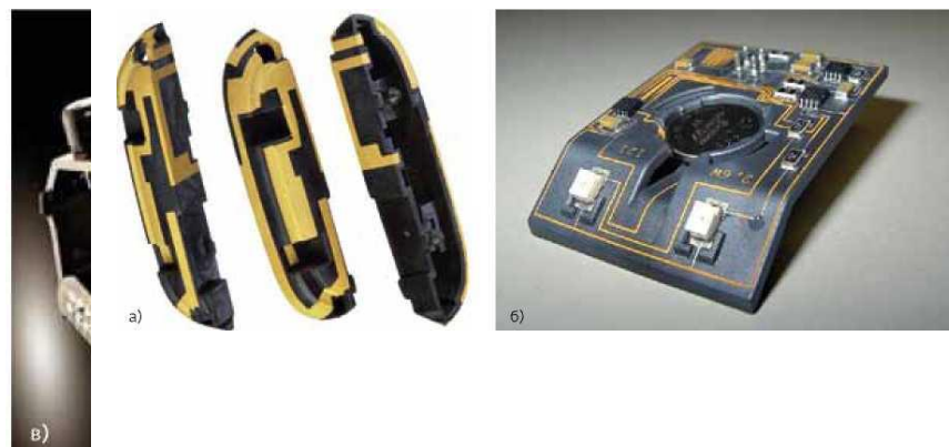
Рисунок 1.3 – Примеры изделий 3D-MID: антенна мобильного устройства (а); миниатюрное электронное устройство (б); деталь рукоятки мотоцикла (в)
