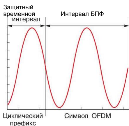
Рис. 14.2. Структура символа в OFDM на одной поднесущей с добавлением префикса
