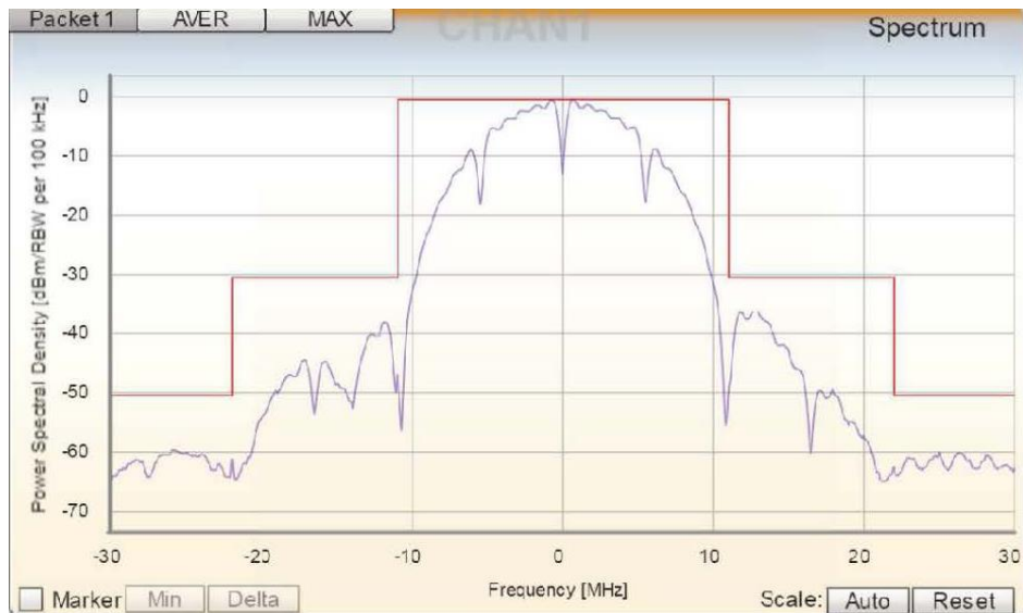
Рис. 13.4. Спектральная маска и спектр реального сигнала спецификации 802.11b DSSS
