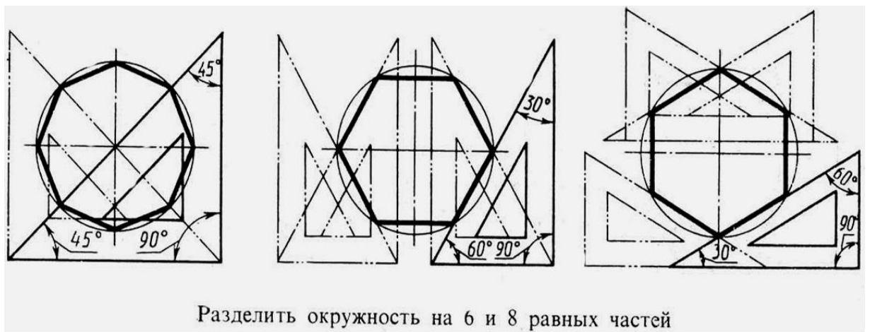
Рисунок 2 – Деление окружности на равные части с помощью треугольников
