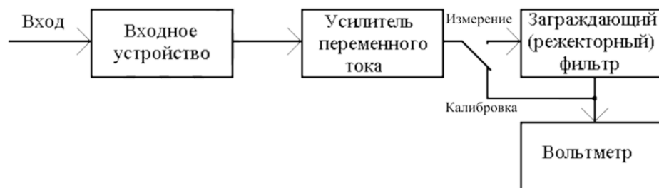
Рисунок 15.1 – Упрощенная схема измерителя нелинейных искажений
