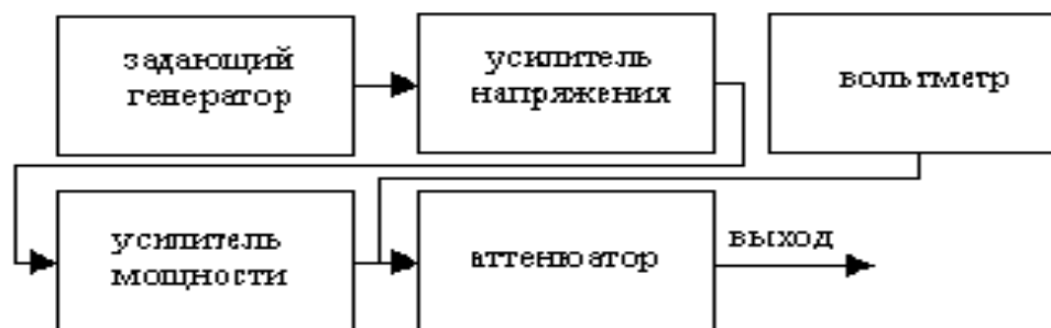
Рисунок 2 – Структурная схема низкочастотного генератора
