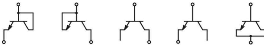
Рисунок 7 – Транзисторные структуры в диодном включении
