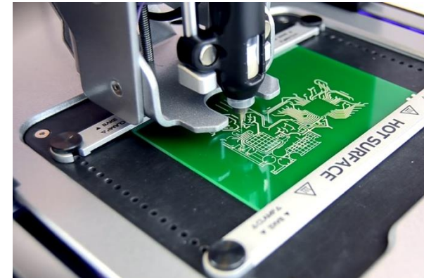
Рисунок 2.5 – Печать проводящего рисунка печатной платы специальными чернилами с высоким содержанием серебра
