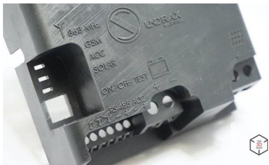
Рисунок 2.10 – Корпус электронного устройства, изготовленный методом SLS.
