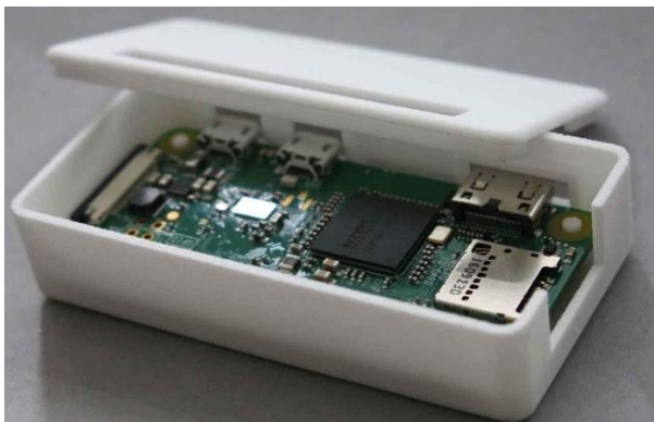
Рисунок 2.9 – Корпус электронного устройства, изготовленный методом FDM.
