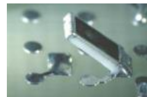
Дефект «надгробный камень»
