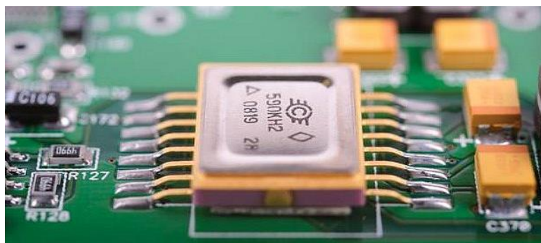
Рисунок 7.1 – Виды паяных соединений SMD
