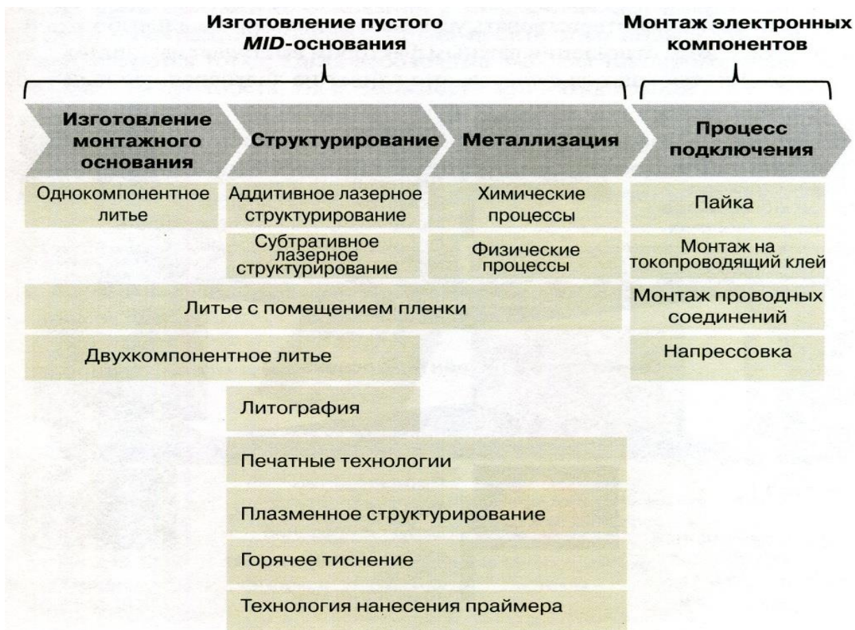
Рисунок 1.5 – Технологический процесс изготовления MID-изделий
