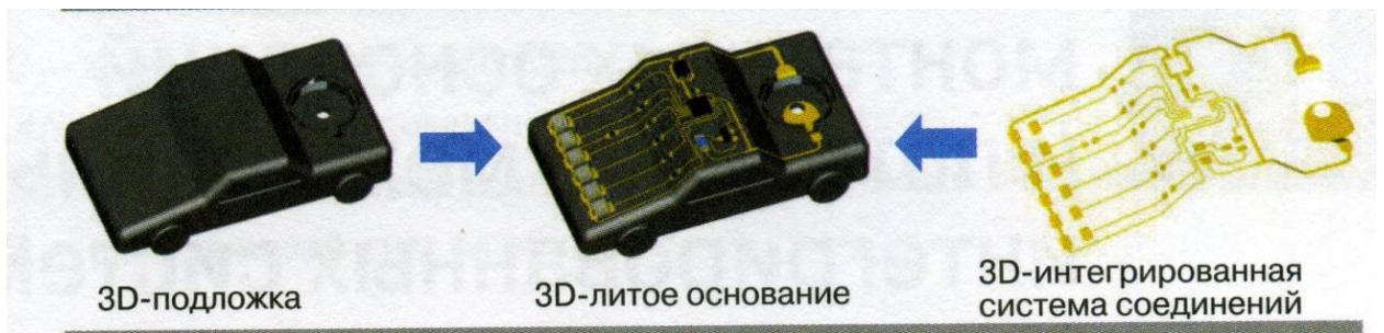
Рисунок 1.3 – Процесс изготовления MID изделий
