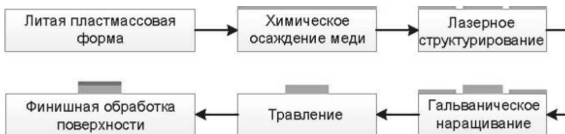
Рисунок 4.4 – Производственная цепь процесса MIPTEC
