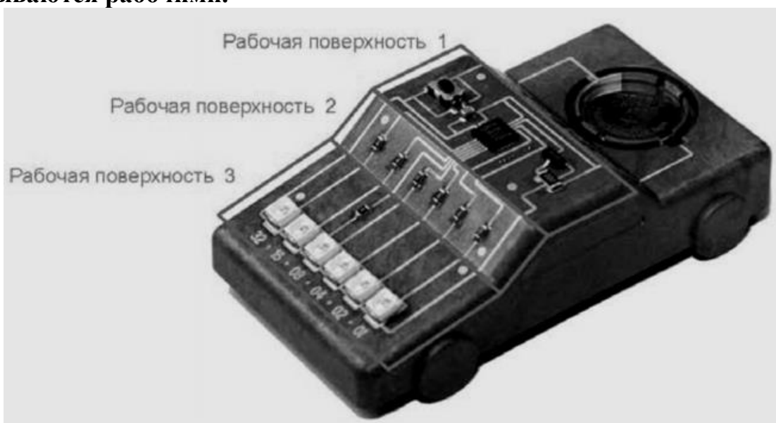
Рисунок 5.2 – Расположение рабочих поверхностей в 3D MID изделии
