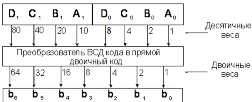
Рис. 4.7. Схема преобразования двухразрядного VCD кода в прямой двоичный код
