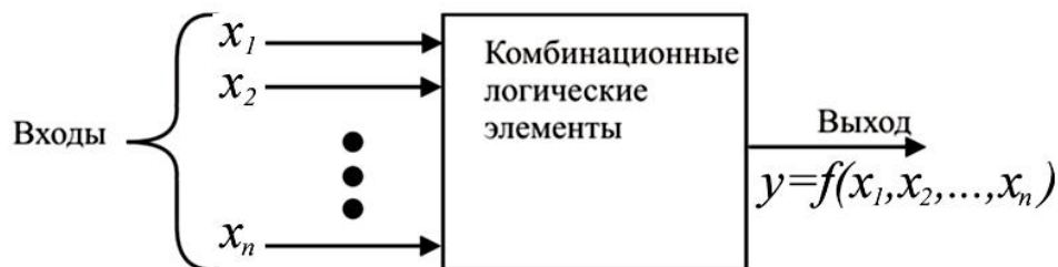
Рис. 13.1. Блок-схема комбинационного устройства
