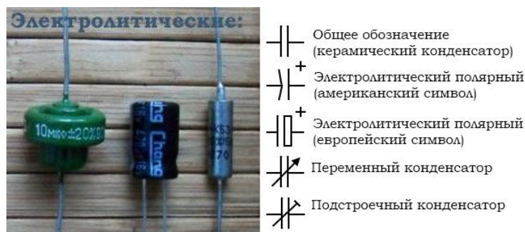
Рисунок 15.2. Электролитические конденсаторы для объемного и печатного монтажа
