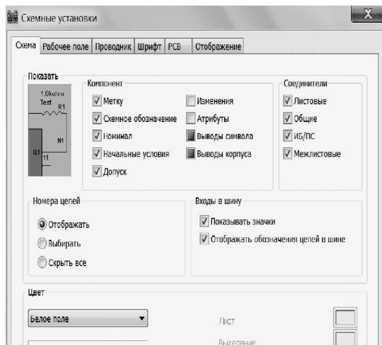
Рис.14.5 – Установка номеров соединений
